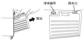
●冷凝水可以通过排水管直接排出。 将蓄水桶取出,卸下出水口挡块,把排水管 直接套接到机器的排水口上,也可以先将排 水管从机器底部的圆孔中穿过,再套接到机 器的排水口上。
